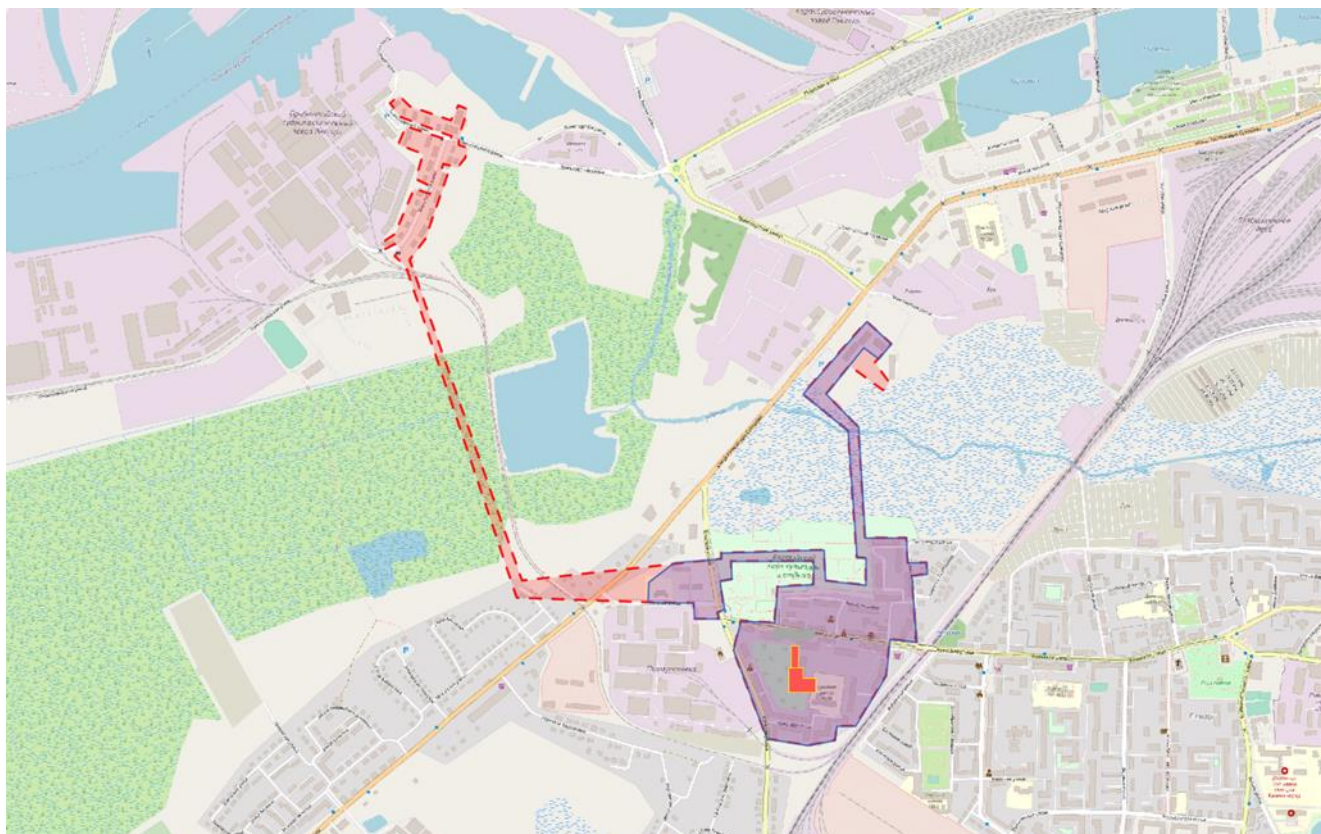
Рисунок 2.6. Схема изменения зоны действия котельной ул. Киевская, 141а (синим цветом обозначена существующая зона действия, красным – планируемое изменение зоны действия к 2035 году)
